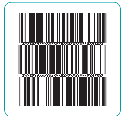
Abb. 5: GS1 DataBar Expanded mit 40 verschlüsselten Zeichen (vergrößert dargestellt)
