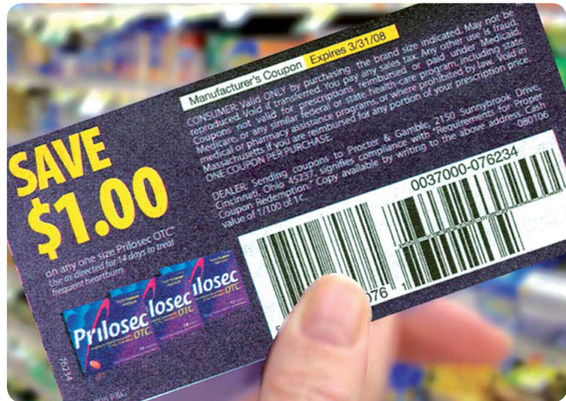
Abb. 6: Beispiel eines Coupons in den USA mit einer nationalen GS1 DataBar-Lösung
